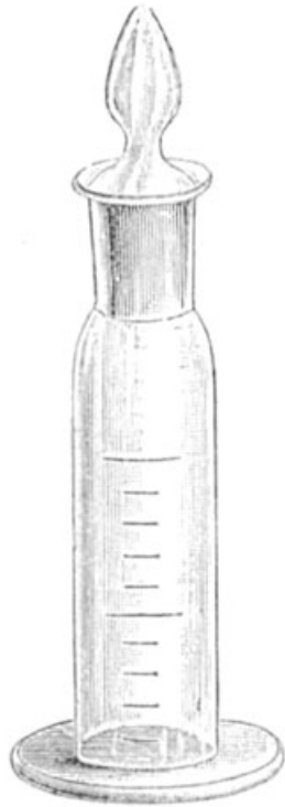
Halbschematische Abbildung des Sedi- mentierungsgefäßes. Natürliche Grösse.
